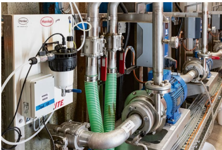
Die Vorbehandlungsbecken wurden auf chromfreie Vorbehandlung vorbereitet und mit energiesparenden Aggregaten ausgerüstet.
