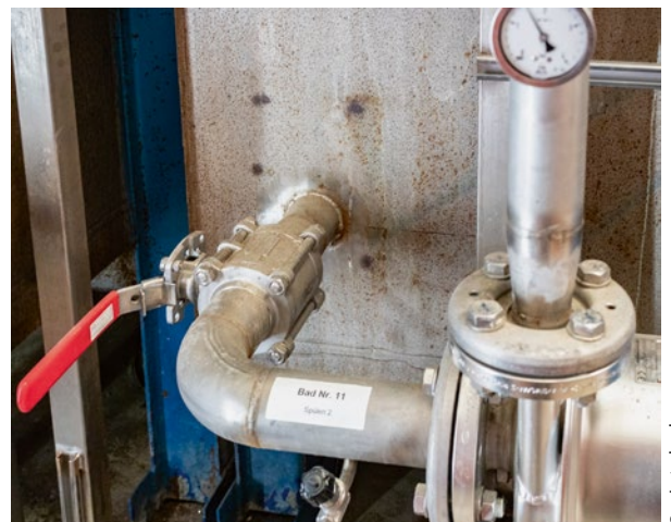
Die Vorbehandlungsbecken wurden auf chromfreie Vorbehandlung vorbereitet und mit energiesparenden Aggregaten ausgerüstet.
